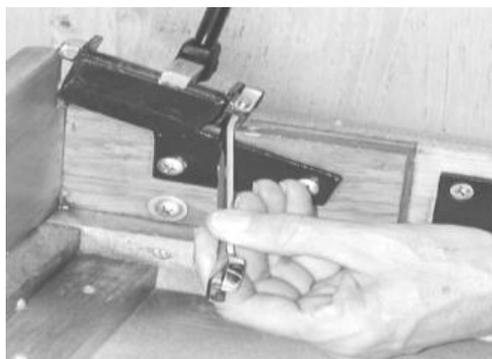
**NEVER BACK THE ADJUSTING BOLTS BEYOND THE "BED CLOSED" POSITION AS IT WILL LIKELY BREAK THE PISTONS OR CONNECTORS WHEN THE BED IS PUSHED CLOSED.**
